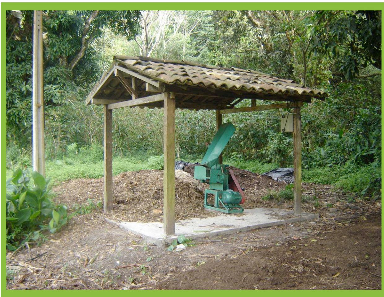
**ILUSTRAÇÃO 6. Triturador de matéria orgânica para o preparo de compostagem, sob proteção de telhado.**
